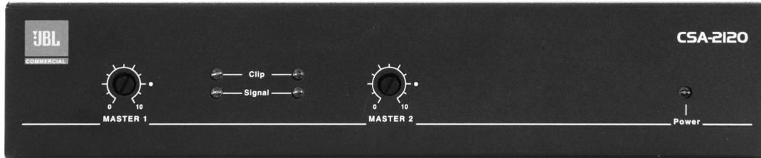
JBL Commercial® CSA-2120功率放大器是为专业音响系统设计和制造的一款安装设备。此功放采用双通道模拟信号输入，带前级信号处理功能，配有切换模式的通用开关电源。此功放提供两个可选附件：安装支架和音频变压器模块CST-2120。使用安装支架可以将功放安装到机柜或墙壁。如果您使用的是高阻抗输入扬声器，您可以将音频变压器接入功放和扬声器系统之间，以达到功放输出电路与扬声器输入电路的阻抗匹配。
